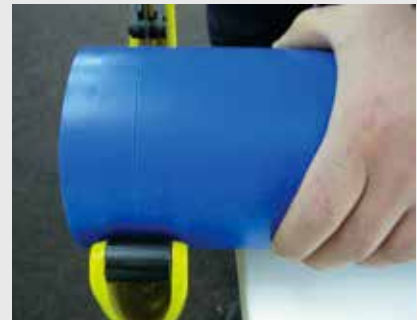
С бавни въртеливи движения, отрежете външния слой PP
