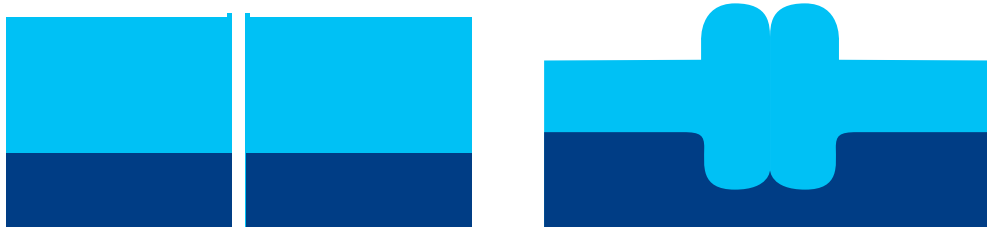
Изравняване на тръбите и свързване, поява на заваръчни шевове при притискане
